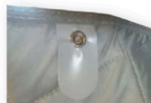
Fixation sur le toit relevable par boutons-pression
